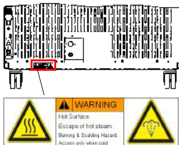
Figura 3: posizione dei cartelli indicatori sul retro dell'apparecchio
